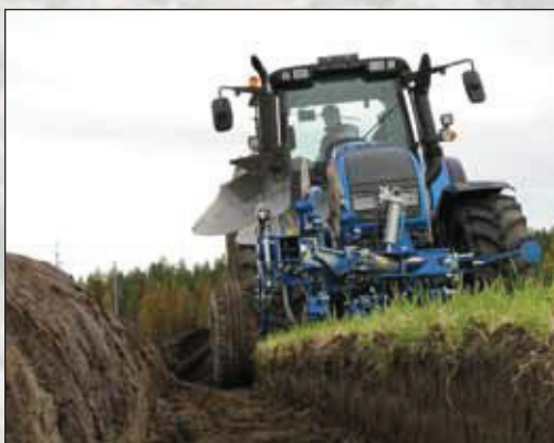
Ein strapazierfähiges Furchenrad bestimmt die Tiefe und Breite der Vorderfurche.
