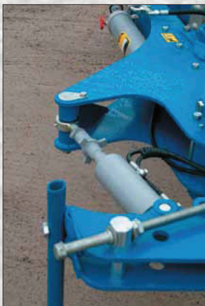
Mit dem hydraulischen Einschwenkzylinder wird der FX-Pflug vor dem Drehen zentriert und anschließend in die neue Arbeitsposition ausgeschwenkt – beides automatisch.
