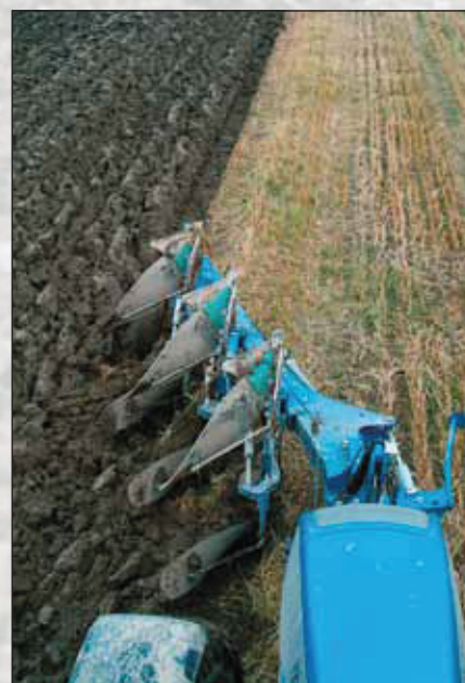
In Arbeitsposition seitlich versetzt zum Schlepper schafft der FX-Pflug eine Furchen für die Schlepperräder.
