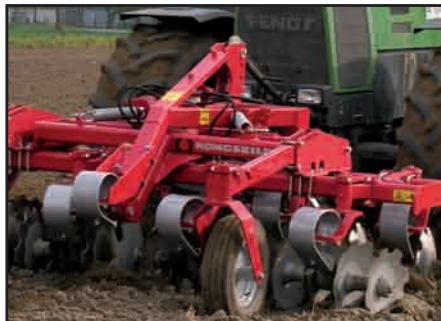
Niedriger Zugpunkt vor der Front Terra Disc.
